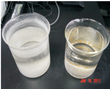
图 1 地热水蒸发浓缩一倍后的结晶污垢观察
