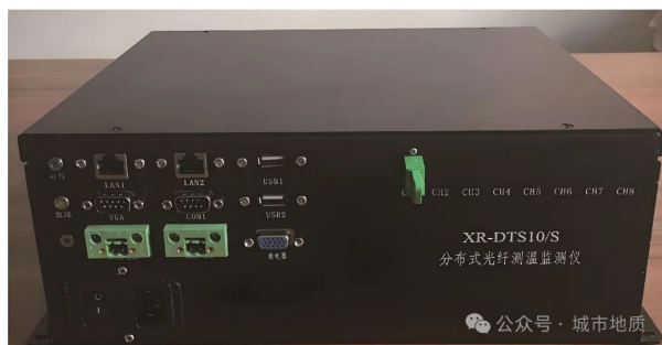
图2 分布式光纤测温系统测温主机
